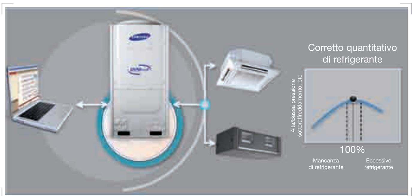
**DVM HR III.** Il sistema a recupero di calore DVM Plus III consente di generare simultaneamente riscaldamento e raffrescamento. Questo tipo di impianto "utilizza" il liquido in uscita dalle unità interne funzionanti in riscaldamento per mandarlo alle unità funzionanti in raffreddamento. Si rivela particolarmente adatto per la climatizzazione di ambienti che necessitano del funzionamento simultaneo in raffreddamento e riscaldamento, come alberghi e uffici.
