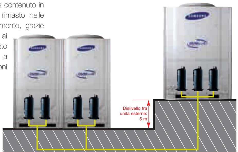
**grande affidabilità.** Anche con tubazioni di lunghezza complessiva di 1000 metri e con dislivello di 40-50 metri, il sistema DVM assicura sempre performance eccellenti grazie all'adozione dello scambiatore Twin Pipe con Intercooler e di una valvola EEV del liquido per controllare il sotto-raffreddamento.
