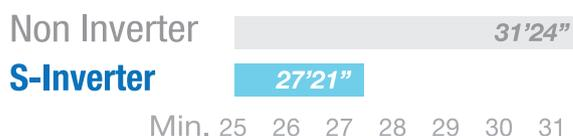
Tempo necessario per diminuire la temperatura in ambiente da  $33^\circ\text{C}$  a  $25^\circ\text{C}$
