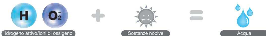
Gli atomi di idrogeno attivo e gli ioni di ossigeno aderiscono alla superficie della particella nociva. La particella nociva si decompone, gli atomi di idrogeno attivo, gli ioni di ossigeno e l'idrogeno della particella si trasformano in acqua che si disperde nell'ambiente.
