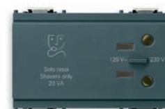
16290 (.B) 230 V~ 50-60 Hz, con trasformatore di isolamento 20 VA, uscite 230 V~ e 120 V~ - 3 moduli
