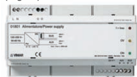
01801 Alimentatore con uscita 29 V d.c. 800 mA, 120-230 V~ 50-60 Hz
