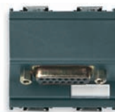
16362 (.B) 15 poli, SUB D, a saldare - 2 moduli
